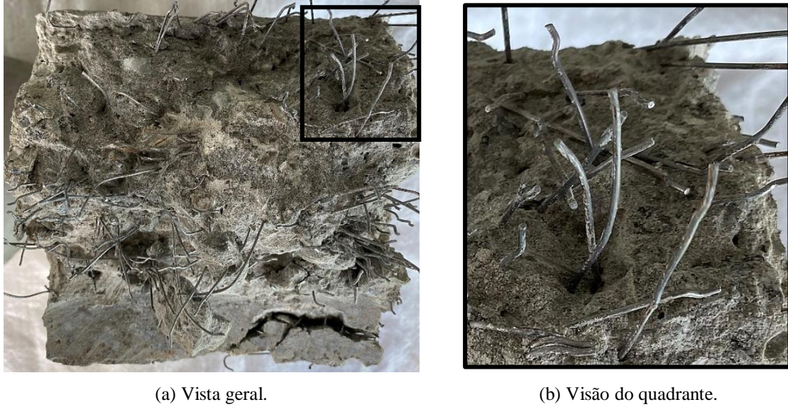
Figura 6.1. Seção transversal A_p do prisma com volume de fibra igual à 1,5%.
